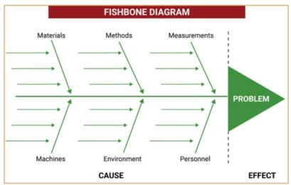
Fig. 3.4.6: Fishbone Diagram
